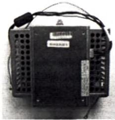
Используется для обеспечения работы блоков осветительных светильников хирургических светодиодных HyLED серии 8, в вариантах исполнения HyLED 8600, HyLED 8600/8600, HyLED 8600/8600/8600, электропитанием 24 В постоянного тока. Монтируется в запотолочном пространстве.
